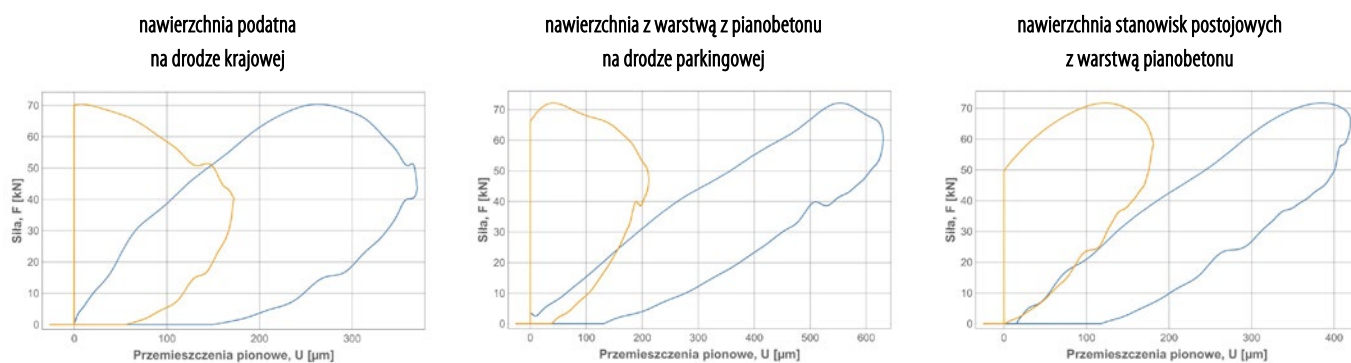
Rys. 5. Wykresy histerezy siła-przemieszczenie dla typowej nawierzchni podatnej i nawierzchni z warstwą z pianobetonu
